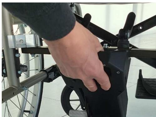
Assicurarsi che il corpo motoruota sia saldamente vincolato alla staffa. Nel caso agire sulle leve portandole in posizione di apertura e ruotandole in senso antiorario (ridurre la forza di chiusura) o orario (aumentare la forza di chiusura).
