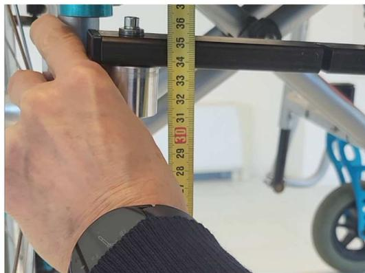
Verificare ancora l'allineamento della staffa e, se necessario, aprire le viti e regolarne ulteriormente la posizione.
