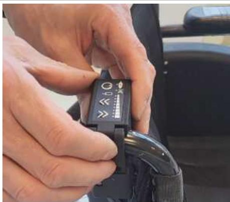
Qualora il diametro del tubo del manubrio fosse inferiore a 22mm, utilizzare la guaina di spessoramento fornita in dotazione, eventualmente tagliata a misura, per spessorarlo opportunamente, in modo da garantire un fissaggio sicuro del comando.
