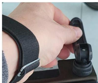
Far scorrere la motoruota sugli appositi alloggiamenti di montaggio presenti nella staffa e poi chiudere le 2 leve.
